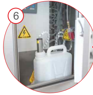
6 Αποθήκευση χημικών σε δοχείο κλειδωμένο μέσα στη μονάδα
